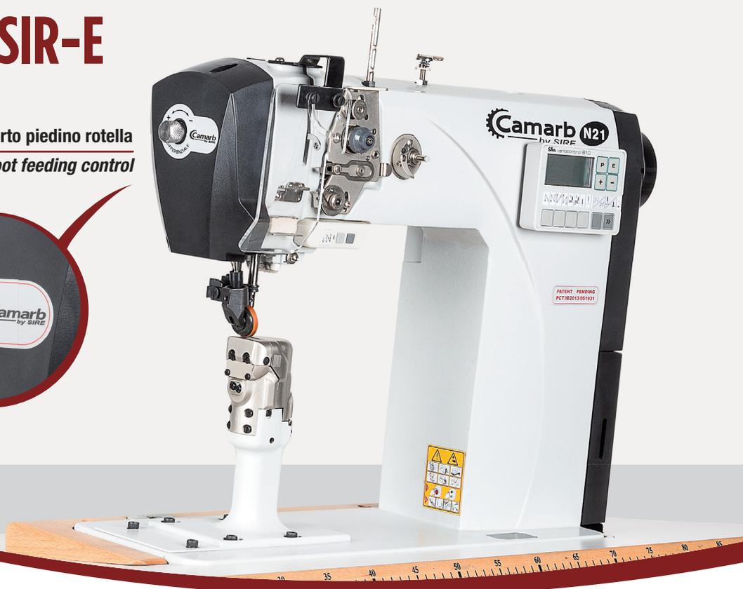
Macchina a colonna stretta 175 mm, 1 ago, trasporto piedino rotella e griffa rotante inferiore comandate da un motore passo-passo, sincronizzato con lo spostamento della barra ago. Dispositivo rasafilo, servocomando elettronico per sollevamento piedino e affrancatura iniziale e finale.
